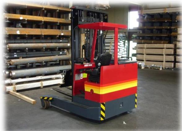
Schubmaststapler mit Gabelneigung  $\pm 2/-0^\circ$  und einer Tragfähigkeit von 6.000 kg bei LSP 600 mm bis zu einer Hubhöhe von 3900 mm.
