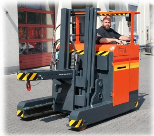
Elektro-Schubmaststapler zum Handling von Langgut im Stahlbetrieb.
