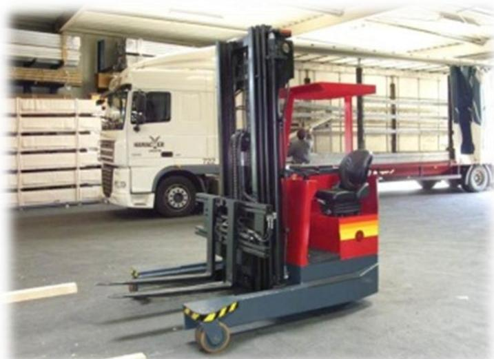
Elektro-Vierwege-Schubmaststapler zum Handling von verschiedensten Stahlrohren. Sowohl das Be- und Entladen von LKW's als auch das Ein- und Auslagern in das Regalsystem ist mit dem Schubmaststapler möglich.
