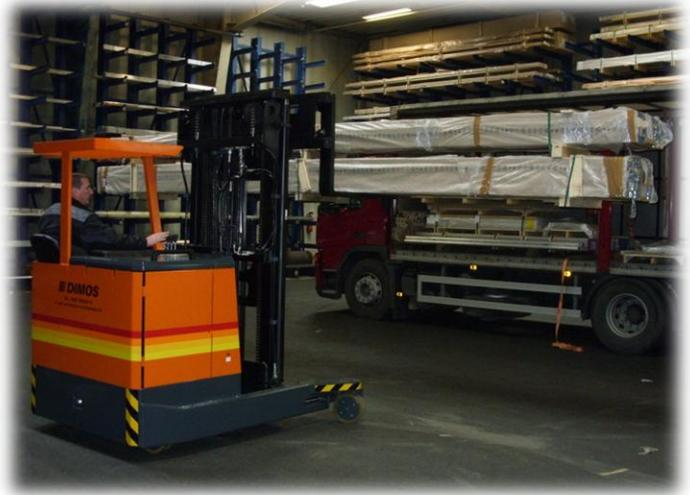
Dieser Schubmaststapler ist für das Ein- und Auslagern in zwei unterschiedlichen Ebenen zuständig.
