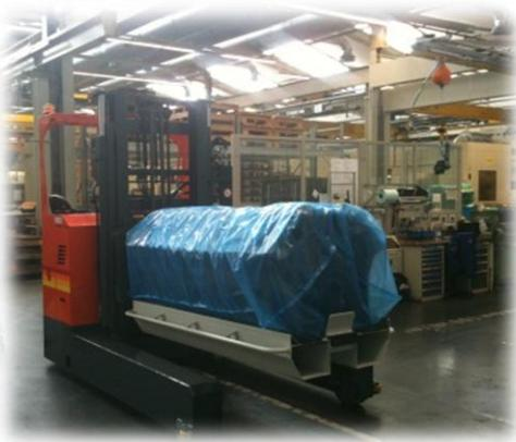
Schubmaststapler für das Handling von Spritzgußwerkzeugen an Maschinen. Dieses Gerät ist mit einem Kranausleger und Aufnahmehaken ausgestattet.
