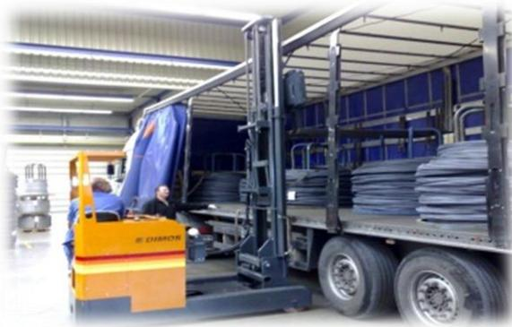
Schubmaststapler zum Handling von verschiedensten Materialien. Er ist mit einem integrierten Seitenschieber  $\pm 100$  mm ausgestattet.
