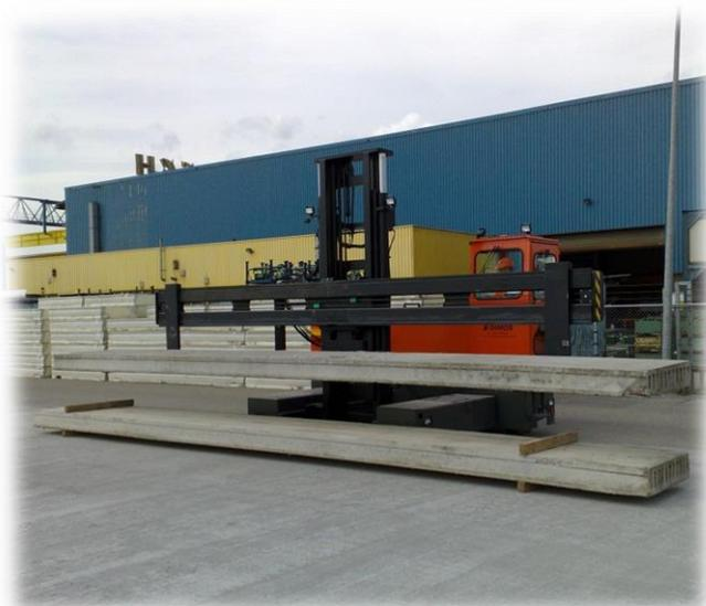
Das Handling von Betonbindern wird mit diesem Elektro-Mehrwege-Seitenstapler vorgenommen. Eingesetzt wird das Gerät im Außenbereich.
