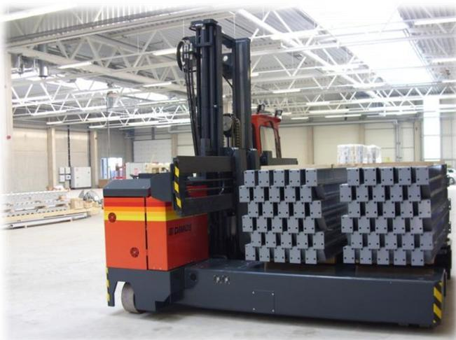
Der Elektro-Mehrwege-Seitenstapler ist für das Handling von Furnierprofilen vorgesehen. Sowohl das Einlagern im Regal als auch die Bestückung der Anlage kann mit dem Gerät vorgenommen werden.
