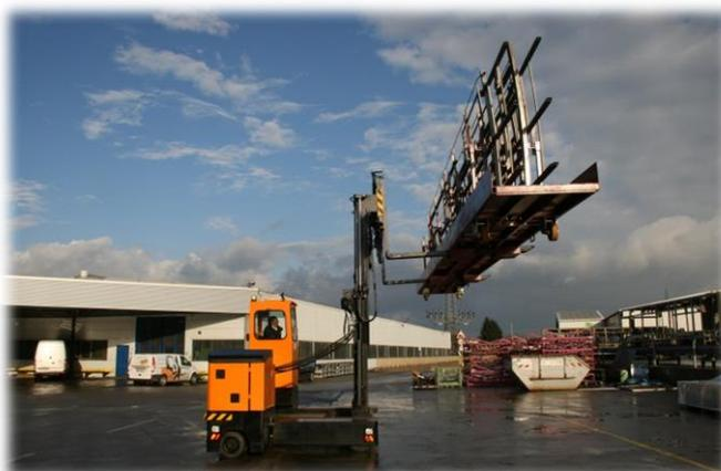
Dieser Elektro-Mehrwege-Seitenstapler ist für das Handling von Buskarosserien vorgesehen. Durch die verbauten Teleskopgabeln ist das einseitige Be- und Entladen von LKWs trotz geringer Nutzbreite möglich. Zur Schonung des Bodens ist das Gerät mit einem Differenzialantrieb ausgestattet. Der Einsatzbereich ist hauptsächlich der Außenbereich.
