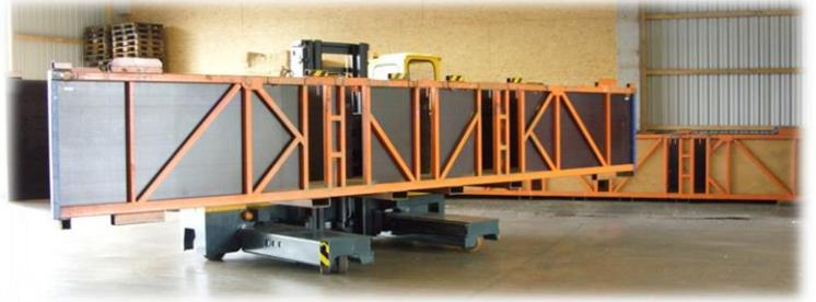
Elektro-Mehrwege-Seitenstapler für das Handling von verschiedenen Holzmaterialien im Schmalgang.
