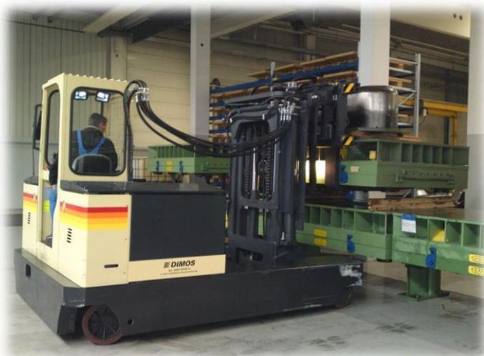
Für das Handling von Pressformen wird dieser Elektro-Mehrwege-Seitenstapler eingesetzt.
