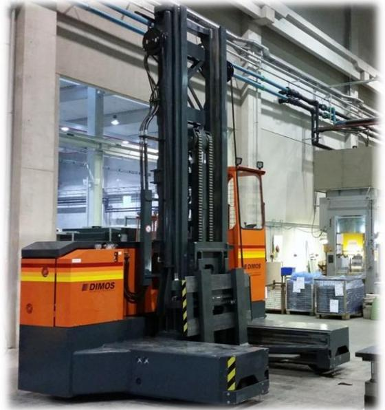
Für das Handling von Holzpaketen mit einer Länge von bis zu 16 m wird dieser Elektro-Mehrwege-Seitenstapler eingesetzt.
