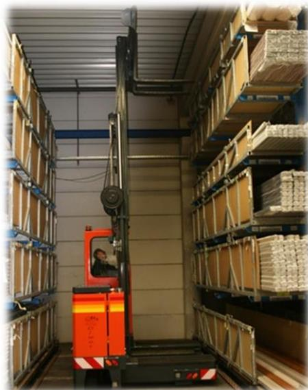
Dieser Elektro-Mehrwege-Seitenstapler wird für das Handling von Kunststoffplatten eingesetzt.
