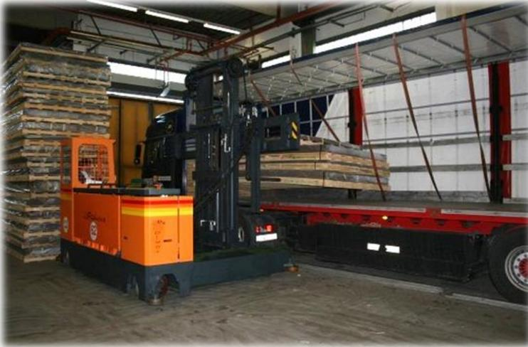
Dieser Mehrwege-Seitenstapler findet seinen Einsatz in der Holzbranche. Mit dem Fahrzeug werden LKW's be- und entladen. Gleichzeitig kann die Ware dann in das vorhandene Regal ein- oder ausgelagert werden.
