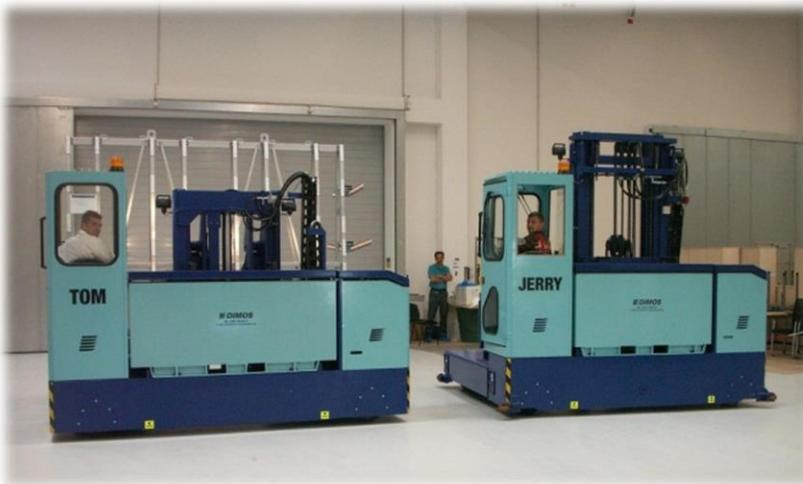
Elektro-Mehrwege-Seitenstapler mit Pendelrahmen ist vorgesehen zum Transportieren von A-Ständern.
