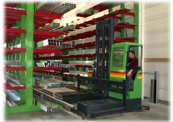
Elektro-Mehrwege-Seitenstapler zum Handling von Stahlrohren im Schmalganglager. Das Fahrzeug hat eine Tragfähigkeit von 4.000 kg und Hubhöhe von 6.500 mm.
